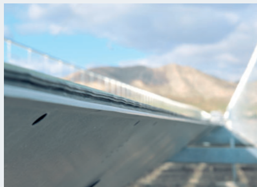
Trotz starker Sonneneinstrahlung hält der Terostat MS-Klebstoff die Spiegel auf den Stahlrahmen.
